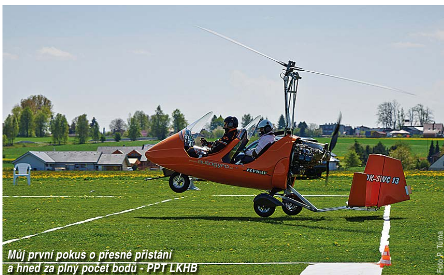
V první fázi rozjezdu je rotor plně přitažen
